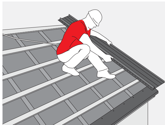
RYS. 16. UKŁADANIE PANELI DACHOWYCH
